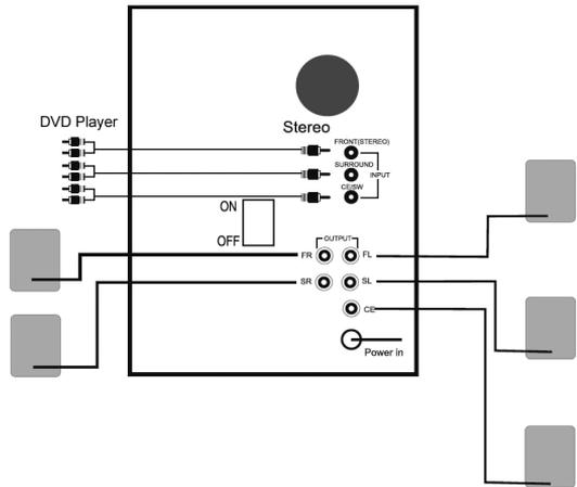
1. lépés: Csatlakoztassa a külső berendezést (DVD) a hátlapon található sztereó bemeneti aljzatba a 3.5mm Jack – RCA\*X2 sztereó kábel segítségével.
