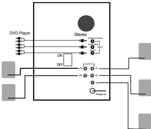
Шаг 1: Подключите внешнее устройство (DVD) к входному гнезду стерео на задней панели при помощи кабеля 3.5мм stereo\_RCA x 2
