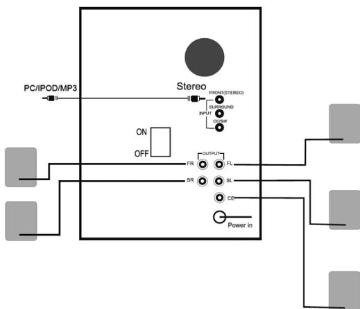
Шаг 1: Подключите внешнее устройство (PC/IPOD/MP3) к входному гнезду стерео на задней панели при помощи кабеля стерео 3.5мм.
