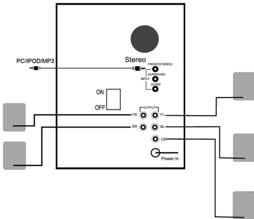
Schritt 1: Schließen Sie das externe Gerät (PC/IPOD/MP3) an Stereo-Eingangsbuchse im hinteren Panel mittels einem Stereo-Kabel 3.5mm an.
