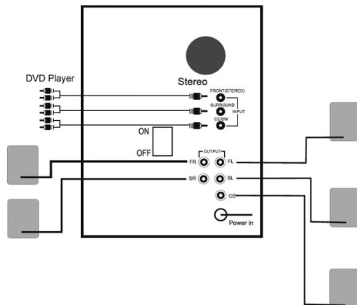
Krok 1: Podłącz urządzenie zewnętrzne (odtwarzacza DVD) do gniazda wejściowego stereo na tylnym panelu za pomocą kabla 3.5mm Jack – RCA x 2
