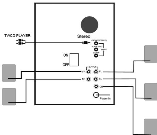
Krok 1: Vnější zařízení (televizor/CD přehrávač) zapojte pomocí kabelu 3.5 mm stereo jack-RCA x 2 do vstupního konektoru stereo na zadním panelu.
