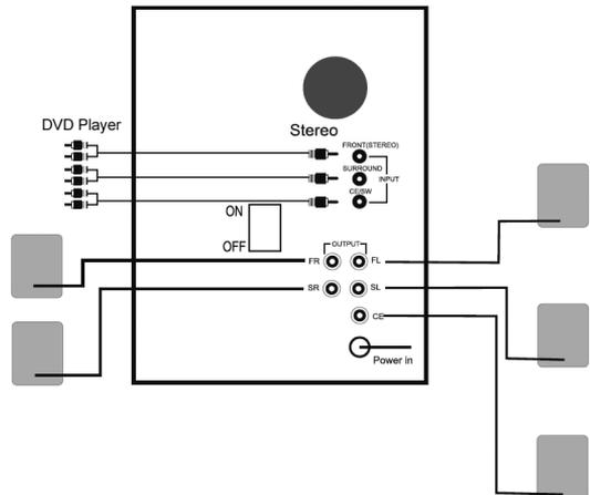
Schritt 1: Schließen Sie das externe Gerät (DVD Player) an Stereo-Eingangsbuchse im hinteren Panel mittels einem 3.5 mm stereo jack-RCA x 2 an.
