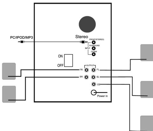
Krok 1: Podłącz urządzenie zewnętrzne (PC/IPOD/MP3) do gniazda wejściowego stereo na tylnym panelu za pomocą kabla stereo 3.5".
