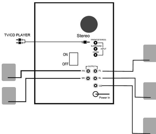
Шаг 1: Подключите внешнее устройство (телевизор/проигрыватель CD) к входному гнезду стерео на задней панели при помощи кабеля 3.5мм stereo\_RCA x 2
