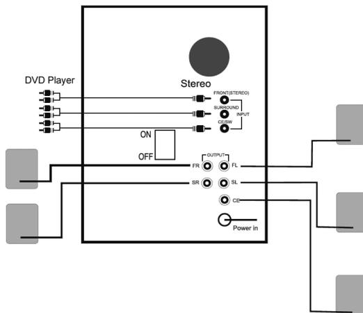
Krok 1: Vnější zařízení (DVD) zapojte pomocí kabelu 3.5 mm stereo jack-RCA x 2 do vstupního konektoru stereo na zadním panelu.
