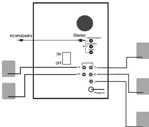
Krok 1: Vnější zařízení (PC/IPOD/MP3) zapojte pomocí kabelu 3.5 mm stereo jack do vstupního konektoru stereo na zadním panelu.
