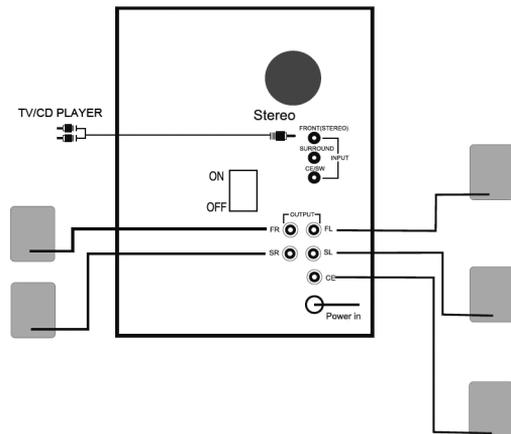
1. lépés: Csatlakoztassa a külső berendezést (TV készüléket/CD lejátszót) a hátlapon található sztereó bemeneti aljzatba a 3.5mm Jack – RCA\*X2 sztereó kábel segítségével.
