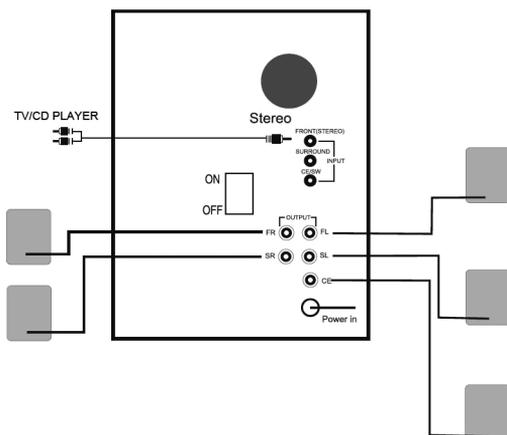
Krok 1: Podłącz urządzenie zewnętrzne (telewizor/odtwarzacz CD) do gniazda wejściowego stereo na tylnym panelu za pomocą kabla 3.5mm Jack – RCA x 2
