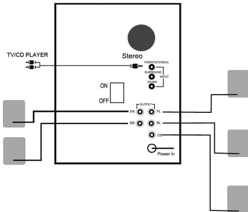
Schritt 1: Schließen Sie das externe Gerät (Fernseher/CD-Player) an Stereo-Eingangsbuchse im hinteren Panel mittels einem 3.5 mm stereo jack-RCA x 2 an.
