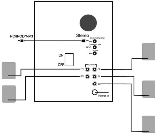
1. lépés: Csatlakoztassa a külső berendezést (PC/IPOD/MP3) a hátlapon található sztereó bemeneti aljzatba a 3.5mm sztereó kábel segítségével.
